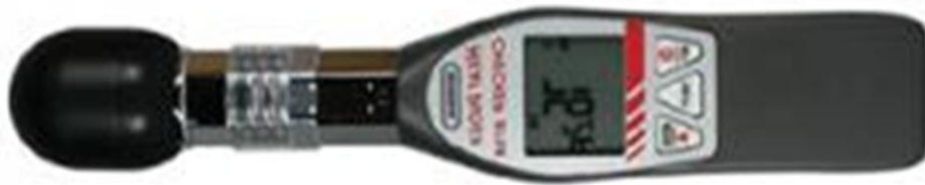
Slika 3a. Uređaj za mjerenje IVGT indeksa
